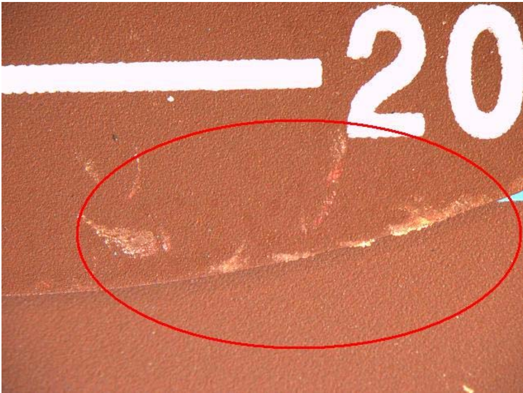
Bild 10: Künstlicher Horizont mit Lackspuren (○) des Pitch Reference Symbols
